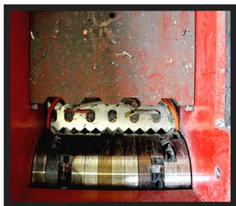
wnętrze komory rozdrabniania GMP100 i zestaw noży do wstępnego rozdrabniania kabli
